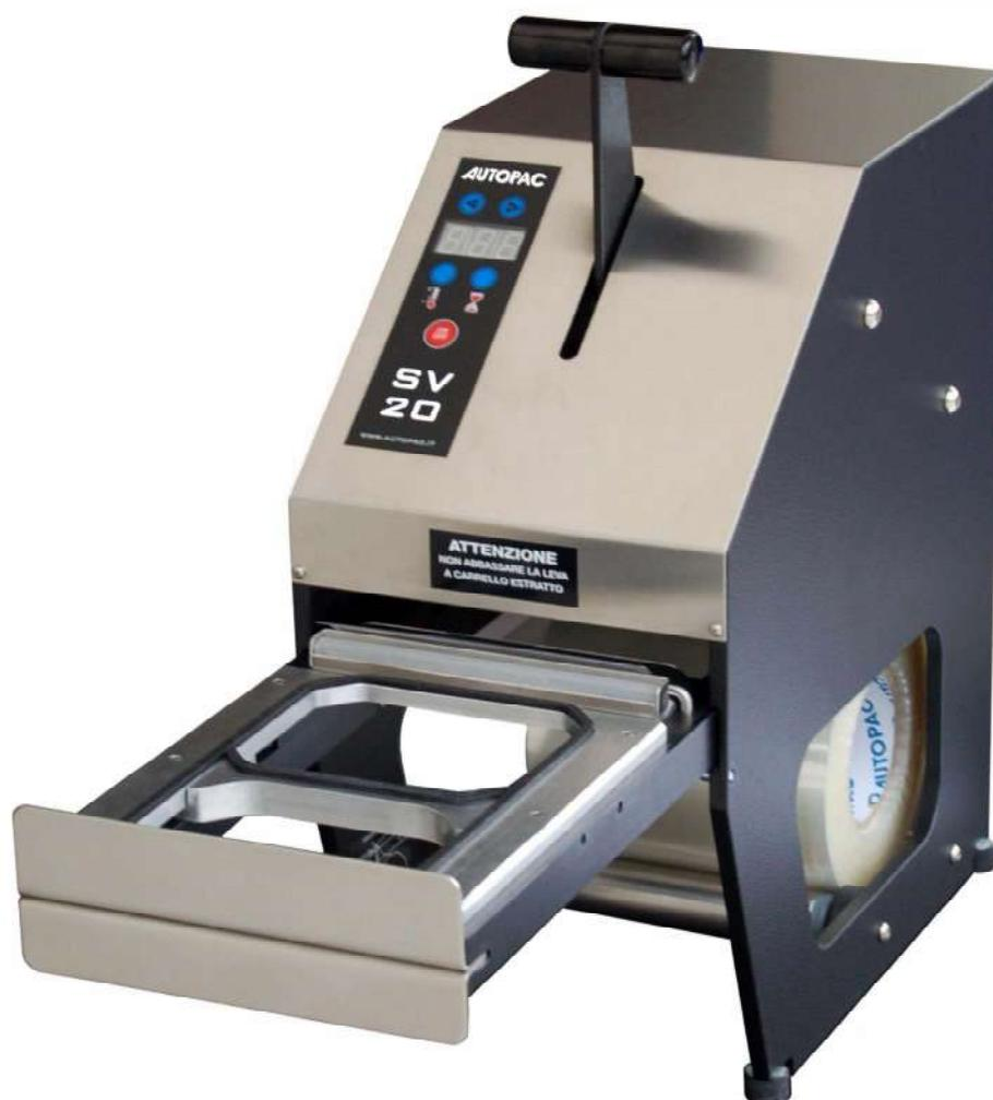
Termosaldatrice manuale multiformato
